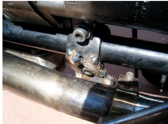
Abb6.: der verstärkte und verschweißte Buzetti „Made in Germany“
